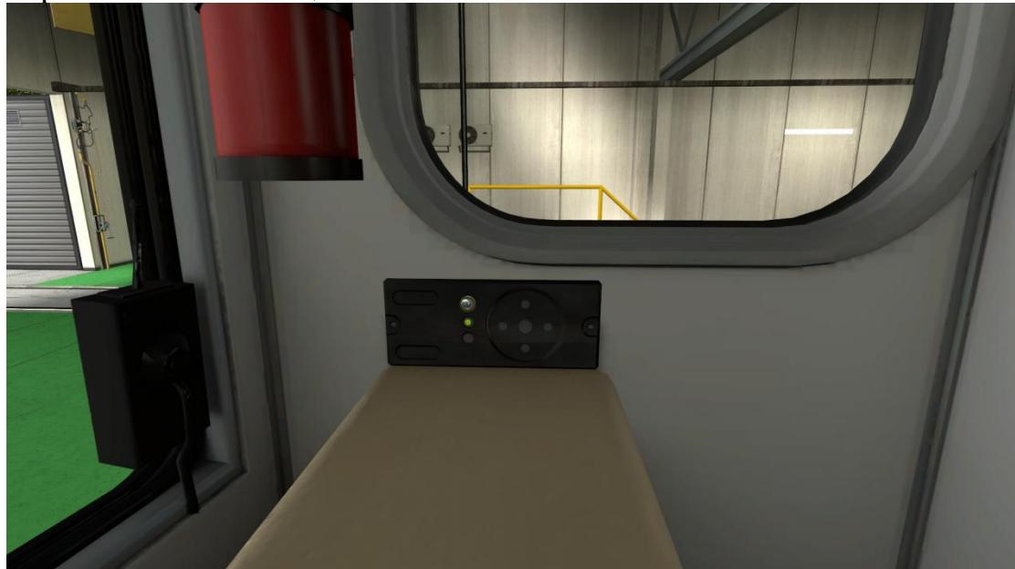
Охранная сигнализации срабатывает при открытии двери из кабины машиниста в пассажирский салон, отключить сигнализацию можно переключением тумблера, либо нажатием кнопки “Звонок” на пульте управления ПОСЛЕ закрытия двери.
